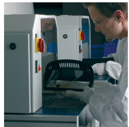
Durch den Zusammenschluss mehrerer Unimaster Vario und einer zentralen Versorgungseinheit ESUC mit Absaugung kann ein kostengünstiger Mehrpersonalarbeitsplatz eingerichtet werden. By joining various Unimaster Vario and a central suction and control unit ESUC, a cost effective working place with several cleaning stations can be implemented.
