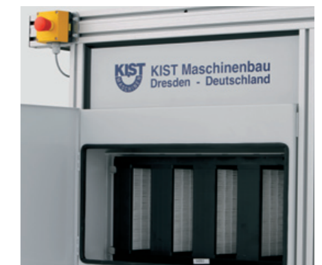
Die Filtereinheit lässt sich ohne Spezialwerkzeug wechseln. Ein fälliger Filterwechsel wird vom Traymaster automatisch angezeigt. The filter unit can be changed without specialist tools. The Traymaster automatically displays when the filter needs changing.
